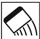
Рекомендуем производить нанесение шпатлёвки при температуре 20°C, при помощи шпателя толщиной не более 2-4 мм за один слой. Для улучшения адгезионных свойств первый слой наносить с максимальным усилием.
